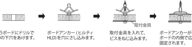
石こうボードにドリルでφ10の下穴をあけます。 → ボードアンカー(ヒルティHLD)を穴にさし込みます。 → 取付金具を入れて、ビスをねじ込みます。 → ボードアンカーが石こうボードの内側に広がり、固定されます。
